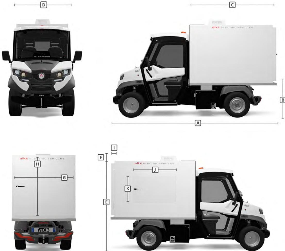
Box frigo disponibile in due dimensioni con gruppo frigo certificato posizionato a tetto e controllo remoto con LCD in cabina. Temperatura di esercizio 0°C / +4°C. Compatibile con l'omologazione stradale N1 dei veicoli su cui è installato.
